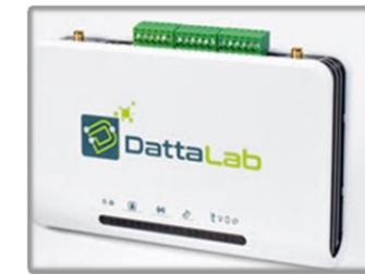
Disponen de un **módulo GSM/GPRS** que, junto con una batería interna autorecargable, asegura el **envío de alarmas mediante mensajes SMS** a listas de números de teléfono aun en caso de falta de suministro eléctrico.
